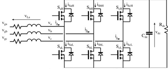
Figure 1. Three Phase Rectifier.
